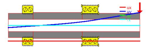
Zusatzmassen können für jede Welle definiert werden. Der Kreiseleffekt kann berücksichtigt werden und auch ein Campbell-Diagramm steht zur Verfügung. Neben der 2D-Darstellung der Eigenformen steht auch eine 3D Animation zur Verfügung.
