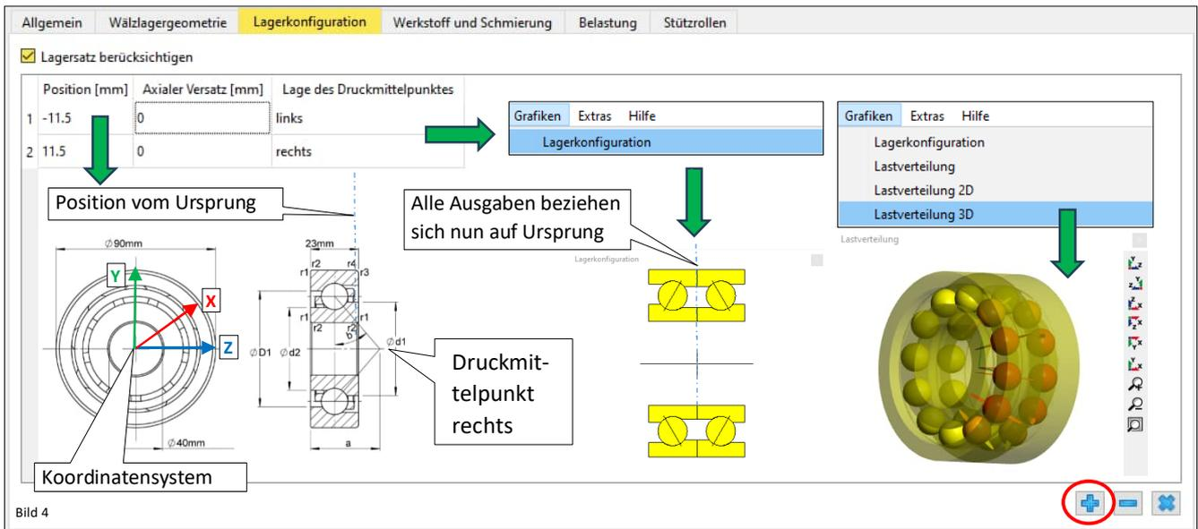
➔ Wählen Sie das generische 7308B und Aktivieren Sie "Lagersatz berücksichtigen", vergeben Sie die Positionen und Lagen der Druckmittelpunkte mittels Zufügen von Zeilen über die Schaltfläche +, gemäss Bild 4.
